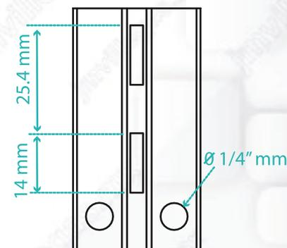
Descripción: Cremallera en "T" con ranuras ocultas, paso 1", fabricado en lámina calibre 13 y 18, galvanizado.
